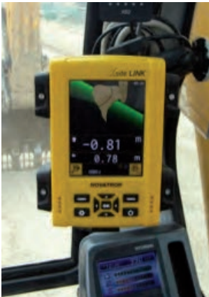
图四：机手只需看一眼显示屏便可获悉挖机铲斗位置—也可以知道需要挖掘的位置
