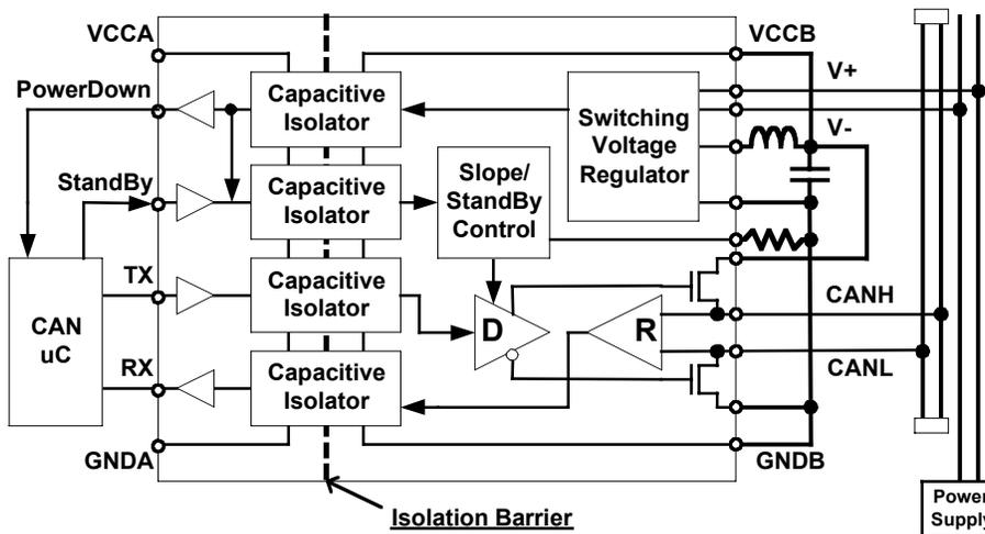
Fig. 3. Block Diagram.
